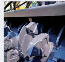
Rotor à profil ls en acier (DCR) pour les deux types d'outils
