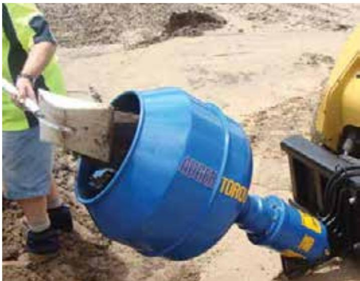
Idéale pour les entrepreneurs de clôtures, avec l'aide du cardan de suspension, la vrille peut être rapidement enlevée et la bétonnière fixée et verrouillée avec l'axe standard de la vrille. Après le béton posé, la vrille peut être remplacée pour la prochaine tâche. Lorsqu'elle est utilisée sur des chargeurs compacts, la bétonnière nécessite l'utilisation d'un berceau qui est monté facilement sur tous nos tabliers porte-fourches.
