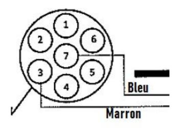
Cela ne peut venir que deux endroits, soit votre batterie tracteur n'a plus suffisament de puissance et par conséquent elle n'envoi plus de courant constant (ou un fil entre la batterie et la prise tracteur est sectionné ou mal branché) (Cas A). Sinon, le cas B est qu'un mauvais branchement a été réalisé en usine sur la prise située sur le treuil.
